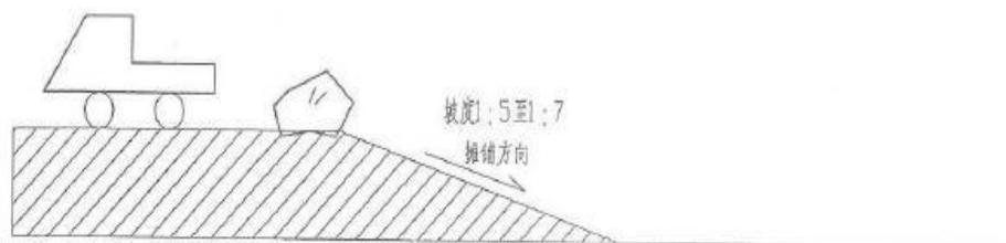
图 3-2-4 粉煤灰摊铺作业方法示意图
